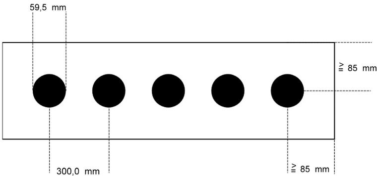
Der Durchmesser des Spiegels beträgt 59,5 mm. Die Klappscheibengrößen ergeben sich aus den Durchmessern der Blendenöffnungen.
