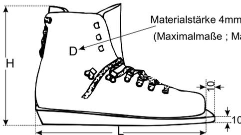
$$\begin{aligned} \text{Höhe} &: \text{Länge} \\ &= \\ H &: (L + 10\text{mm}) \\ &= \\ &2 : 3 \end{aligned}$$
