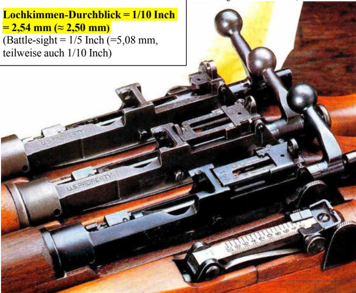
Untere Waffe = ein No.1 Mk III mit „offenem“ Schiebisier, darüber ein No 4 mit Schiebe-Lochkimme, die 3. von unten = Spindel-Lochkimme; oben ein No. 4 mit einfacher Klapp-Lochkimme aus Kriegsproduktion
