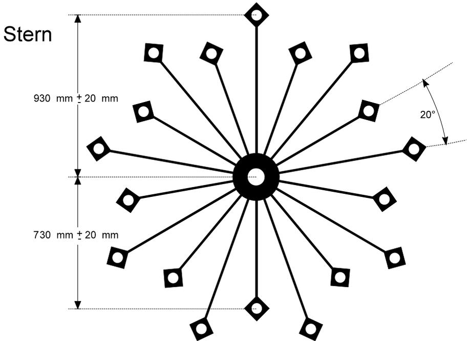
Die Haltestäbe sind in 90 mm und 150 mm Entfernung von der Plattlmitte zuerst von unten und dann von oben bis 1 mm über die Mitte des Haltestabs einzusägen.
