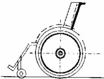
Kein Teil der Rückenlehne eines Schießstuhles darf die in diesen Bestimmungen festgelegte Maximalhöhe einschließlich und insbesondere die vertikalen Seitenrohre der Rückenlehne, überschreiten. (siehe Bild).
