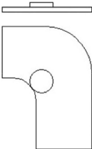
Falls ein größerer Tisch in der Kniendposition benutzt wird, muss ein abnehmbares Brett mit einem Durchmesser von 10 cm und einer Dicke von mindestens 20 mm am Tisch befestigt werden.
