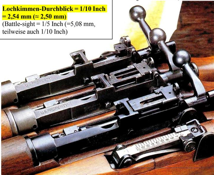
Untere Waffe = ein No.1 Mk III mit „offenem“ Schiebevisier, darüber ein No 4 mit Schiebe-Lochkimme, die 3. von unten = Spindel-Lochkimme; oben ein No. 4 mit einfacher Klapp-Lochkimme aus Kriegsproduktion
