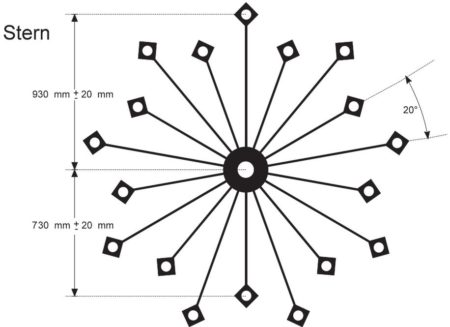
Die Haltestäbe sind in 90 mm und 150 mm Entfernung von der Plattlmittle zuerst von unten und dann von oben bis 1 mm über die Mitte des Haltestabs einzusägen.
