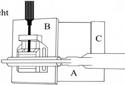
In diesem Beispiel wird die Waffe auf einer ca. 25 x 35 cm großen Grundplatte (A) und einer zweiten, kleineren Platte (B) zur Schussrichtung platziert. Darauf ist, in diesem Beispiel, ein kleiner, handelsüblicher Schraubstock montiert, der die Waffe hält. Andere Halterungen lösen dies durch verschiedene Einsätze oder Federhalterungen.
