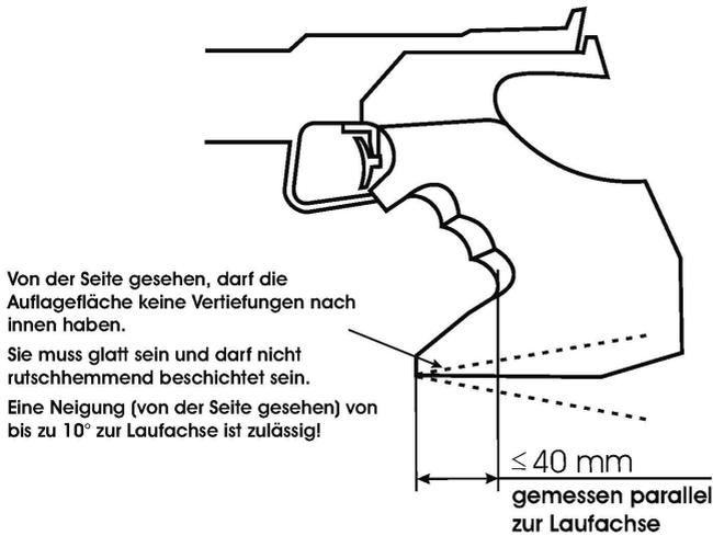
Länge der Auflage, gemessen parallel zur Laufachse, von der Vorderkante bis zur Fingerrille (kleiner Finger) 40 mm. Breite der Auflage bei Luftpistolen und Sportpistole lt. Prüfkasten, bei der Freien Pistole darf die Auflage max. 50 mm breit sein.
