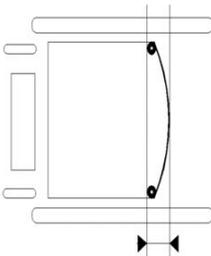
Das Bespannungsmaterial der Rückenlehne darf sich, gemessen von der Vorderkante der vertikalen Seitenrohre der Rückenlehne bis zur tiefsten Stelle der Rückenlehnenbespannung nicht mehr als 8 cm durchdrücken. Bei PVC-Sitzschalen 3 cm. Dieser Abstand ist zu messen, während der Schütze in Anschlagstellung im Schießstuhl sitzt.
