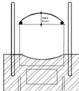
2. Der Schießtisch muss horizontal, oder im gleichen Winkel vom Mittelpunkt des Tisches gemessen, wie der Boden sein. (+/- 5° sind erlaubt)
